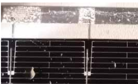
Fehlausrichtung des Busbar-Kopfes
